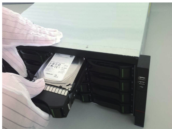
Ilustracja 5: Montaż dysku w rejestratorach z przednimi kieszeniami
