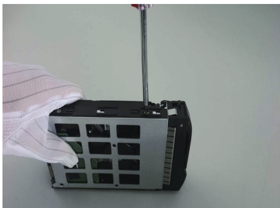
Ilustracja 5: Montaż dysku w rejestratorach z przednimi kieszeniami
