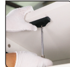
(3). Przymocuj element blokady za pomocą wkrętów
